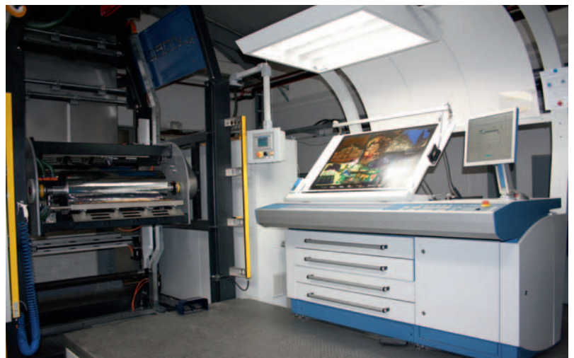
Die Folienladestation befindet sich hinter der Bogenauslage. Der Maschinenführer kann so die Arbeitsvorgänge Drucken und Anlegen leicht bewältigen. Foto: Bünnagel
